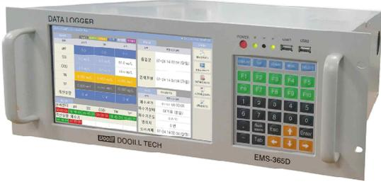
EMS-365D(W) 수질 데이터로거는 「수질 및 수생태계 보전에 관한 법률」을 근거 법령으로 설치 운영 하는 수질TMS의 자료 수집장치이며, 측정기의 성분별 측정값을 수집, 연산, 저장, 전송하는 단말 장치입니다.
