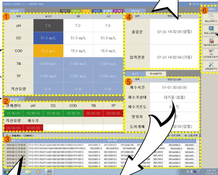
통신상태 화면 : 각 측정기와 데이터로거 및 관제센터의 통신 상태를 시각적으로 표시
